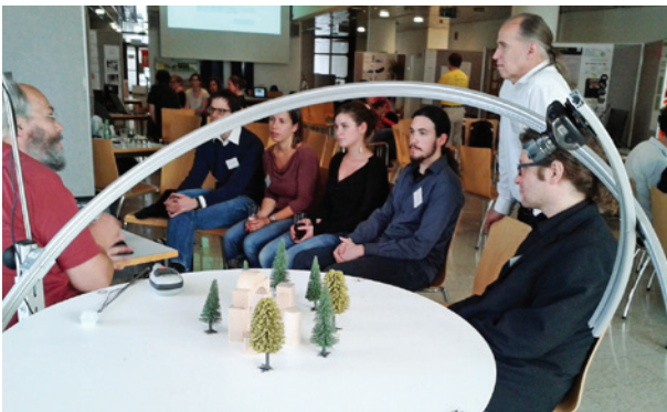
Abb. 4: Links: Sonnensimulator im Rahmen des Lehrmaterials „Sonne und Schatten – Heliodon“. Rechts: Schattenwurf eines Szenarios auf dem Drehteller des „Heliodon“. (Fotos: Richard Kromp)
