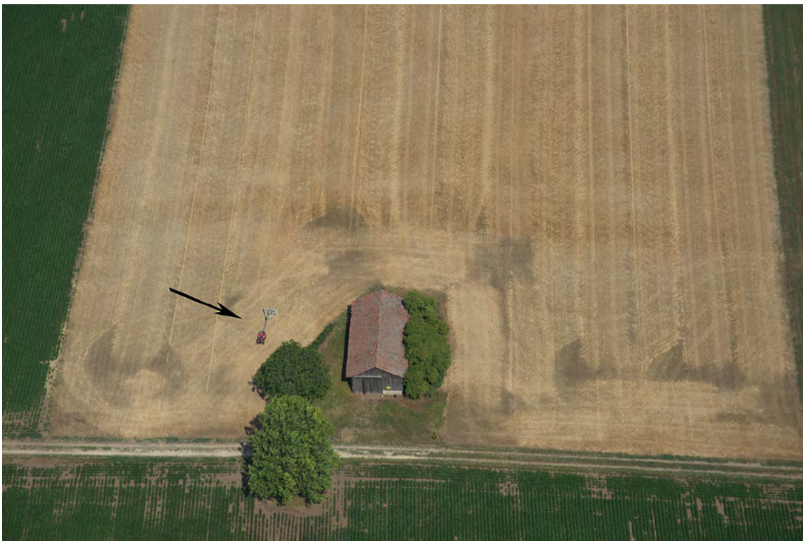
Abb. 8. Ein Luftbild, aufgenommen während der motorisierten geomagnetischen Messungen im Sommer 2014, macht die Größe der Messflächen deutlich. Mit dem Pfeil gekennzeichnet ist das motorisierte System mit einer Messbreite von ca. 2 m (© Luftbildarchiv, IUHA).
