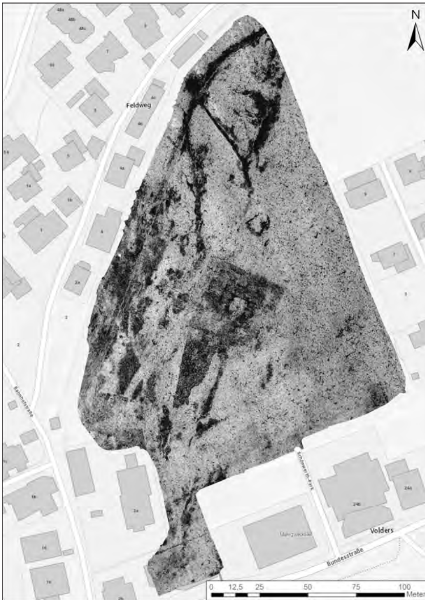
Abb. 8. Volders, Harbfeld: Bodenradar-Tiefenseibe (0,4–0,6 m). Klar ersichtlich sind der quadratische Aufbau der Burg und ihr nach Süden gerichteter Zugang (GPR: LBI ArchPro; Hintergrund: OpenStreetMap contributors).
