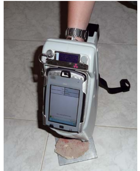
Abb. 2: Toma de datos con el analizador portátil Oxford Instruments, modelo XMET-3000TX+
